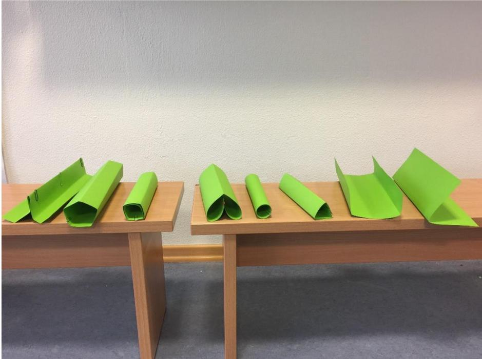
Bild 3: Auf den Schülerbänken vor der Tafel liegen von links nach rechts gefaltete Papierprofile, stabilisiert mit Büroklammern: V- oder Y-Profil, Fünfeck-, Viereck, Herz-, O-, Dreieck-Profile sowie die offenen U- und L- Profile. Die Beispiele aus grünem Karton heben sich visuell gut von der weißen Hintergrundwand und der hellen Holzbank ab.
